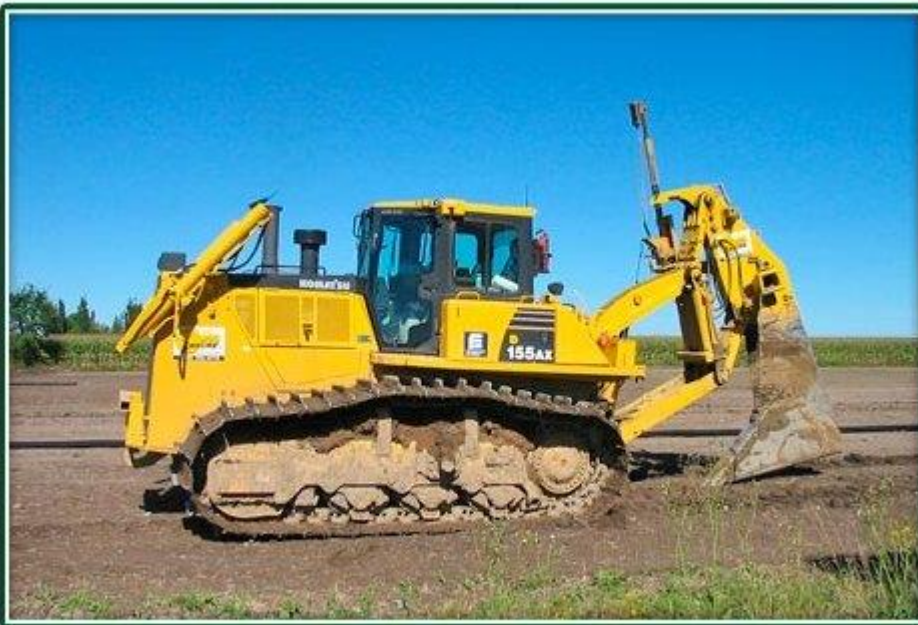
CHARRUE TAUPE ACCRÉDITÉ PAR LE B.N.Q. - DRAINAGE LAZURE INC.
