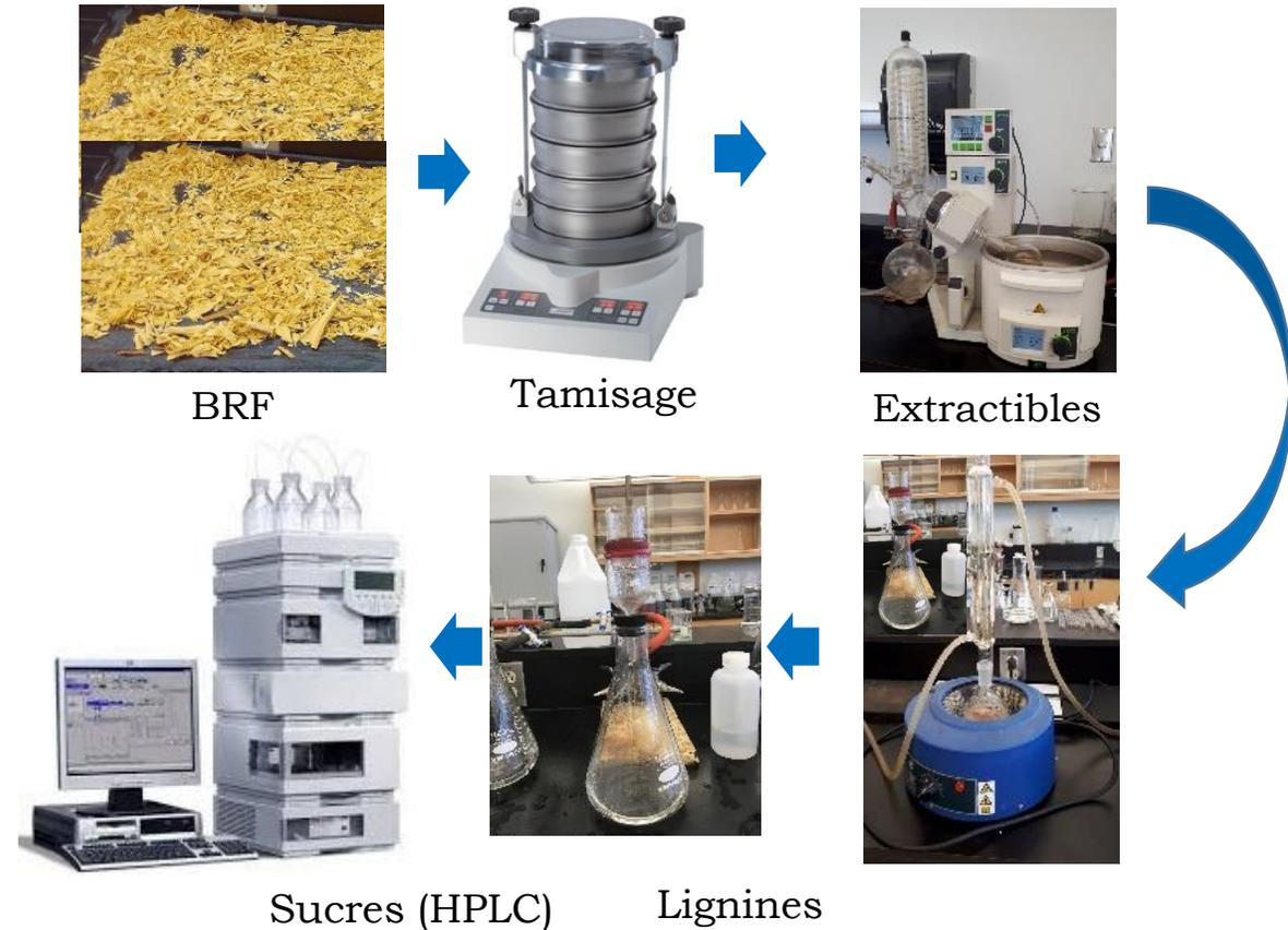
**Figure 3:** Processus de détermination des indices chimiques
